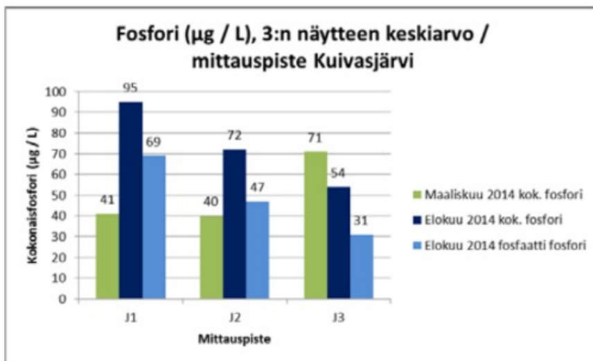
Kuvio 1. Veden kokonaisfosforipitoisuuden ja fosfaattifosforipitoisuuden vaihtelu Kuivasjärven mittauspisteissä (Lähde: Kuoppala 2015, 40).
